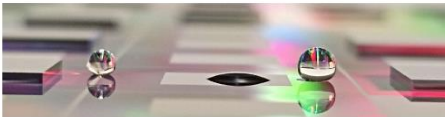
Surface à contraste d'hydrophilie sans PFAS pour le collage des puces
