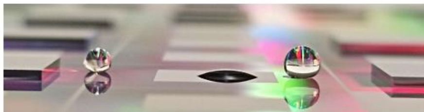
Surface à contraste d'hydrophilie sans PFAS pour le collage des puces
